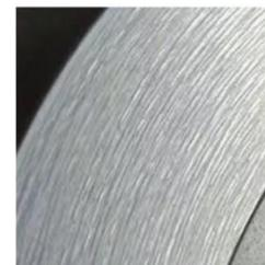
图 4 刹车加工振刀情况
