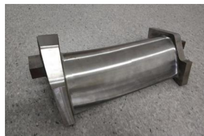
图3 精铸大带冠导叶试件精加工
