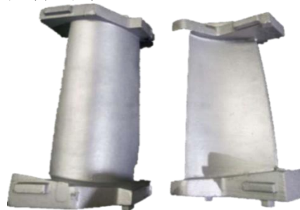
图1 精铸大带冠毛坯示意图
