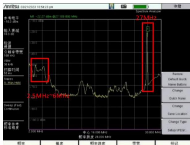
图 2 接地回流线电磁信号测试情况
