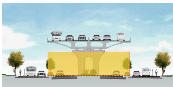
图4 第四步施工期间横断面
