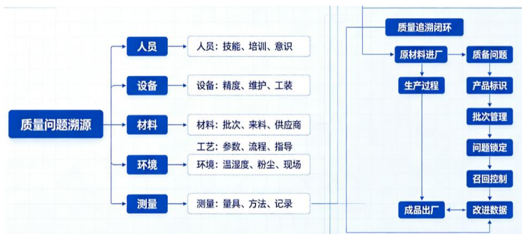
图1 机械制造质量问题因果分析框架
