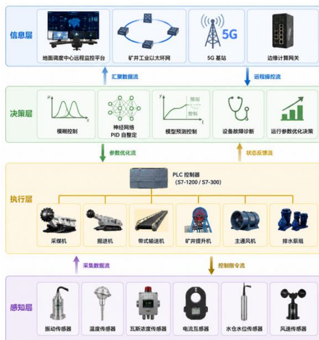
图 1 煤矿机电设备自动化控制系统分层架构图
