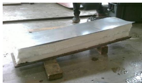
(b) 实验样板铺上保温层
