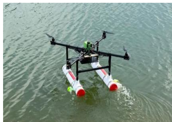
图 2 南京理工大学浮筒式水空两栖飞行器样机图
