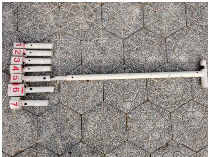
图 1 组合式阀门扳手工作头组(1~7号)和可伸缩操作杆(右)
