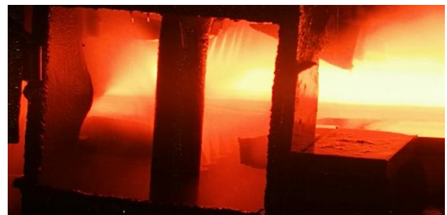
图 2 高压水喷射除鳞效果
