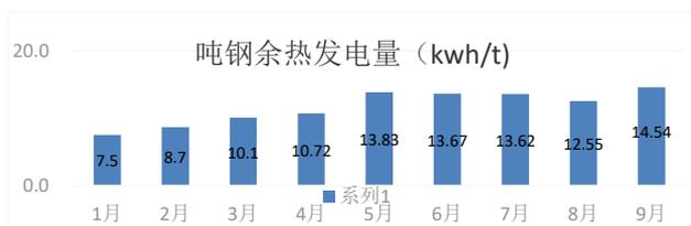
图 5 余热蒸汽吨钢发电量趋势
