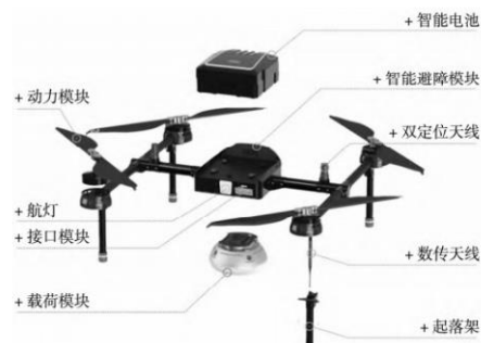
图1 无人机测绘中所用的无人机结构图
