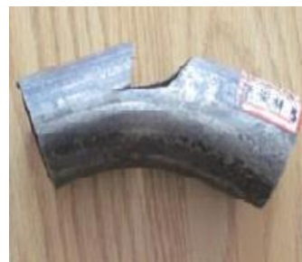
图 2 Q195 材质圆管冷弯开裂缺陷
