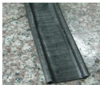
图 1 Q195 材质矩形管压扁开裂缺陷
