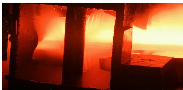
图2 高压水喷射除鳞效果
