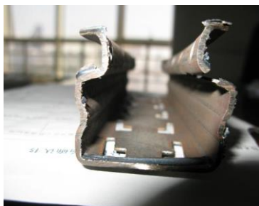
图4 Q235 材质热轧窄带钢成型开裂缺陷
