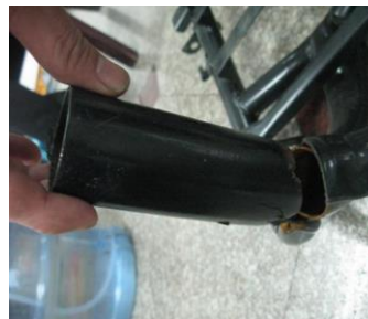
图 3 Q195 材质钢管振动试验断裂缺陷
