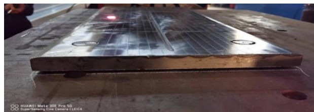
图 7 轧机衬板激光淬火实物
