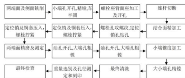
图5 连杆机加工工艺流程
