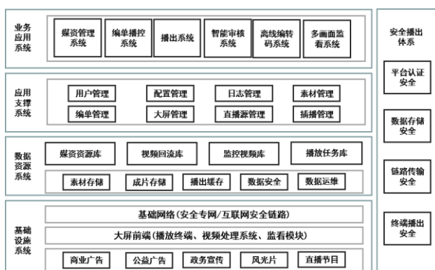
图1 智慧城市户外电子屏联网联控平台总体架构图
