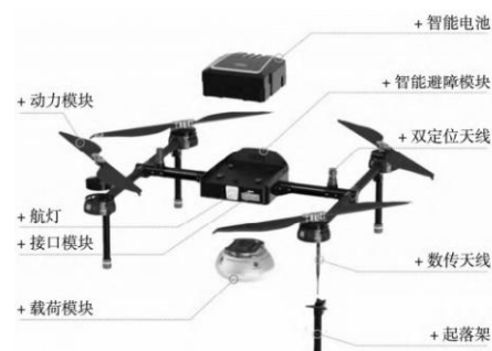
图1 无人机测绘中所用的无人机结构图
