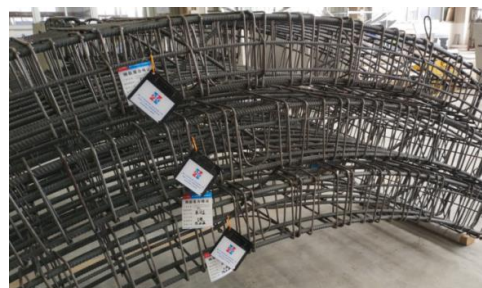
图4 挂在钢筋骨架上的身份识别证
