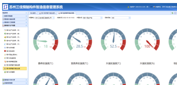
图 14 WEB 综合平台显示的蒸养窑环境动态图
