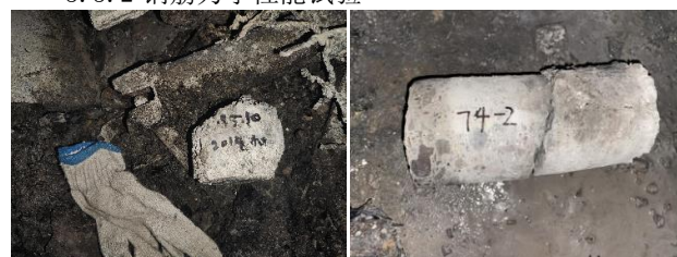
图6 芯样破损典型照
