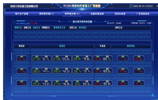
图12 可视大屏显示的蒸养数据和水池水样数据图
