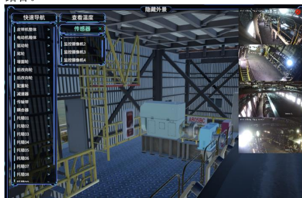
图9 全景摄像头监控与数字孪生结合
