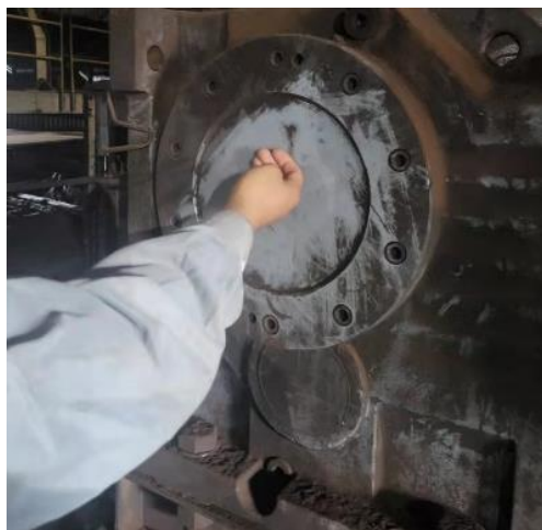
图2 减速机温度检查
