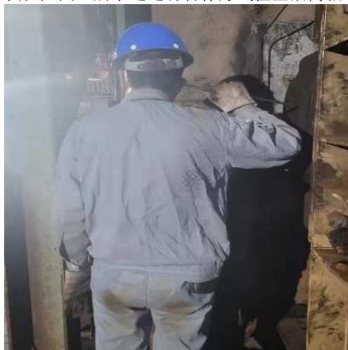
图3 滚筒轴承异音检查
