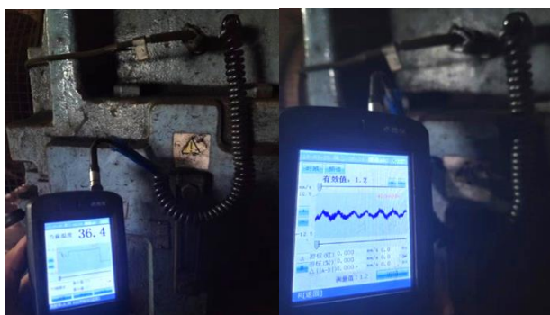
图6 减速机温度、振动监测
