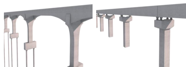
图 1 连续刚构体系与简支体系
