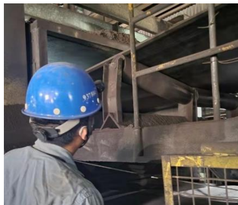
图4 托辊运转情况检查
