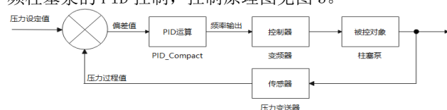
图3 变频柱塞泵PID控制原理图
