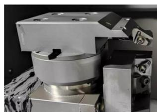
图 3 两刹车面加工刀专用刀组
