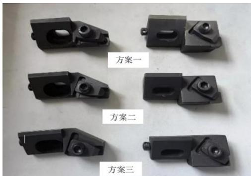
图9 三种方案刀组中刀夹
