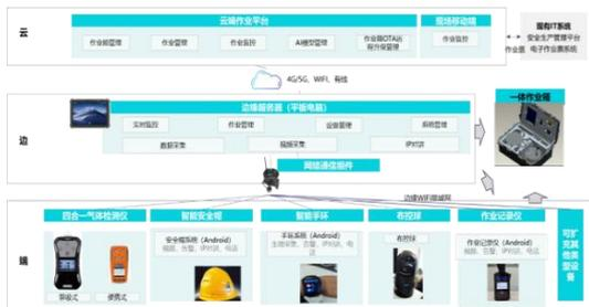
图 1 系统架构图
