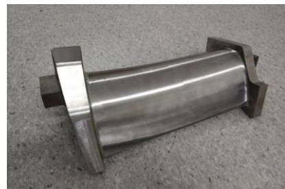
图3 精铸大带冠导叶试件精加工
