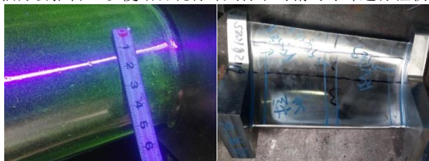
图 4 无损探伤检查
