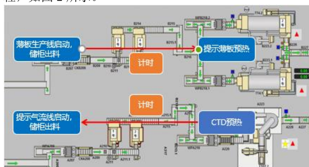
图2 主机预热与生产线运行时间匹配功能示意图
