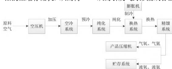
图1 空分装置的运行原理图
