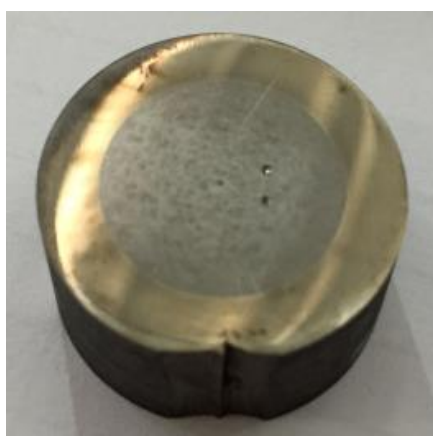
图4 横截面腐蚀形貌
