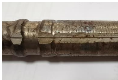
图 1 崩裂中间轴外观
