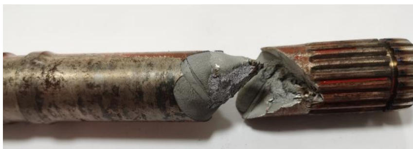
图 8 静扭试验断裂形貌
