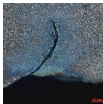
图7 崩裂处金相组织
