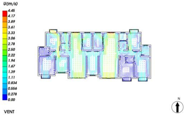
图 6 设置新风系统建筑室内风速矢量图
