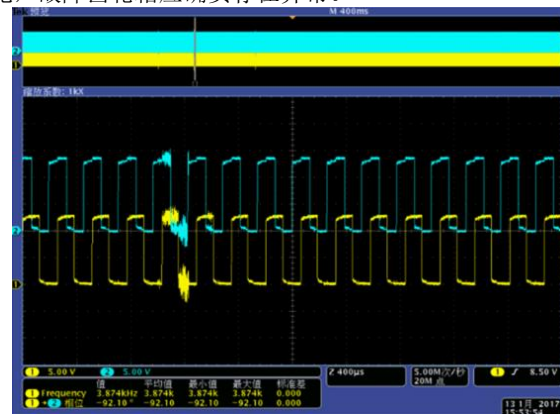
图8 故障齿轮箱上测试速度传感器异常波形
