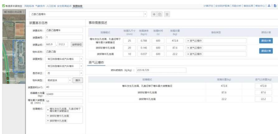
图3 易燃液体泄漏事故情景
