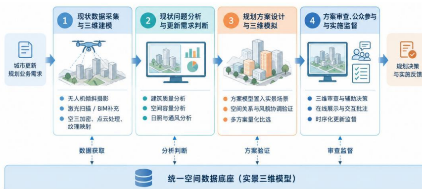
图1 实景三维技术支持城市更新规划的技术路径
