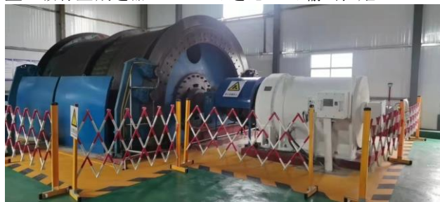
图5 新郑煤电赵家寨煤矿西风井建井2JKZ-4 \times 2.1PY永磁同步减速电机直驱提升机
