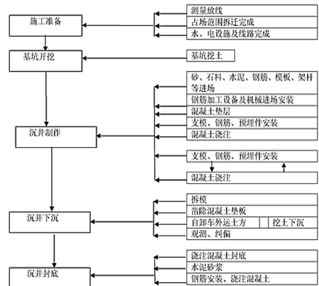
图2 沉井施工工艺流程
