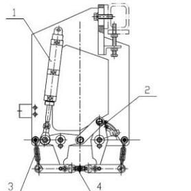
1. 气缸 2. 光电安装板长孔
