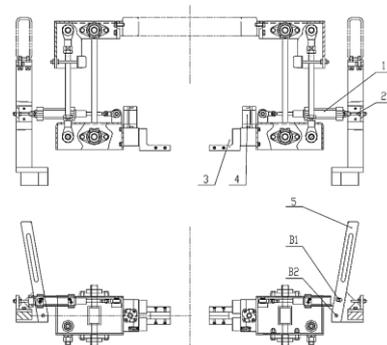
1. 缩袋气缸 2. 螺杆 3. 手爪 4. 夹袋气缸
