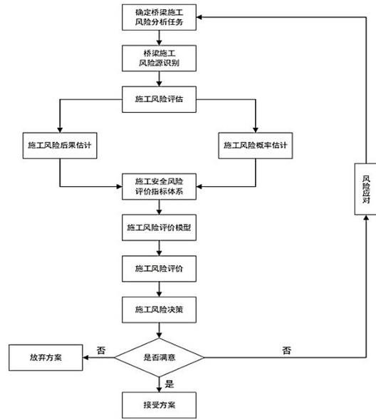
图1 矮塔斜拉桥施工风险分析流程
