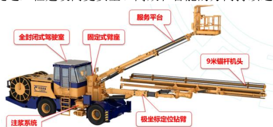
图2 多功能于一体的锚注台车
