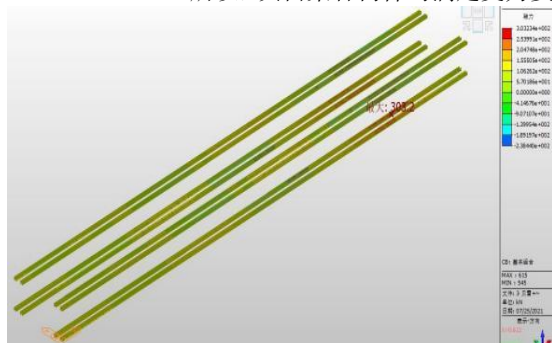
图 1 贝雷梁弦杆内力图
