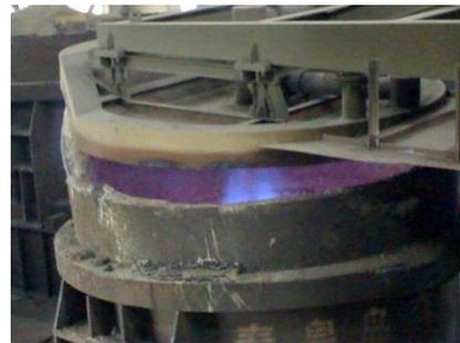
**图5 富氧燃烧时铁水包内火焰**
