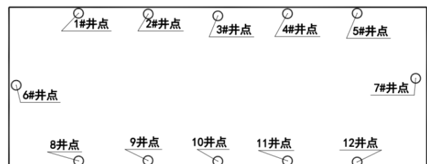
图 1 水池、地坑降水井平面布置图
