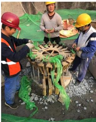
图 4 单桩竖向静载荷试桩试验
