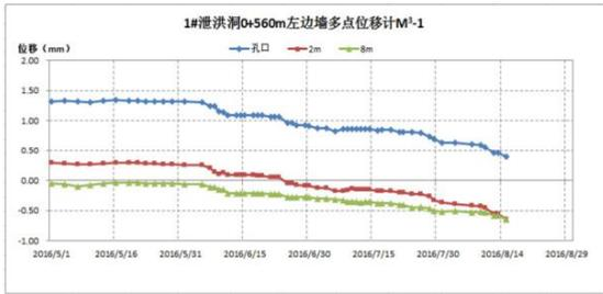
图 3 1#泄洪洞 0+560m 左边墙多点位移计 M<sup>3</sup>-1
