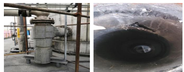
图3 直筒段磨穿泄露
