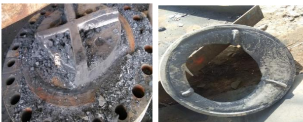
图4 防冲板磨穿泄露
