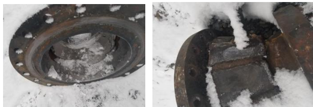
图1 黑水角阀下方喇叭口磨穿泄露
