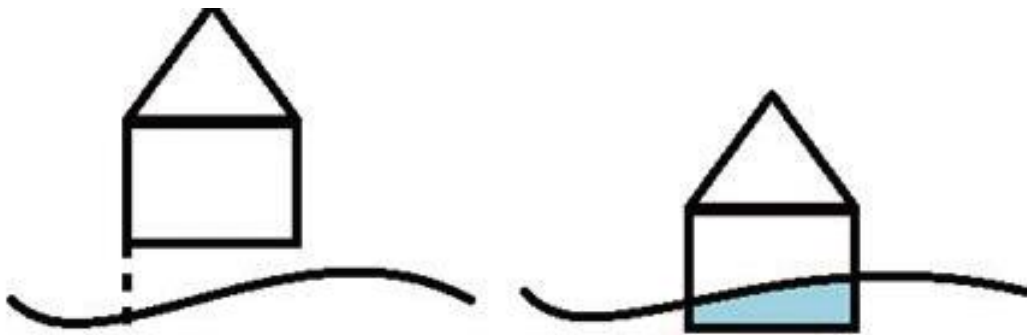
图1 地形模型、建筑物模型未有效匹配
