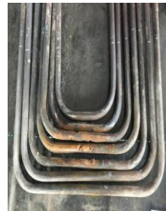
图4 管屏第6~12根泄漏示意图
