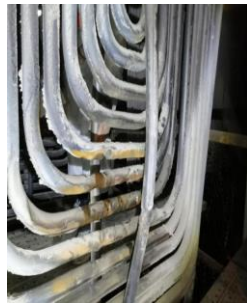
图3 管屏次生漏点示意图
