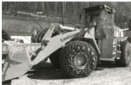
图2 装载机加装防滑链
