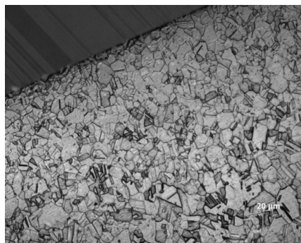
图7 母材外壁金相组织
