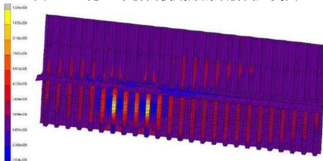
图 18 工况 VI 下桥面板底部的顺桥向应变图
