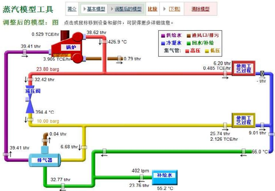
图 2 根据企业现有工况建立的 A. S. T. 建立的基础模型
