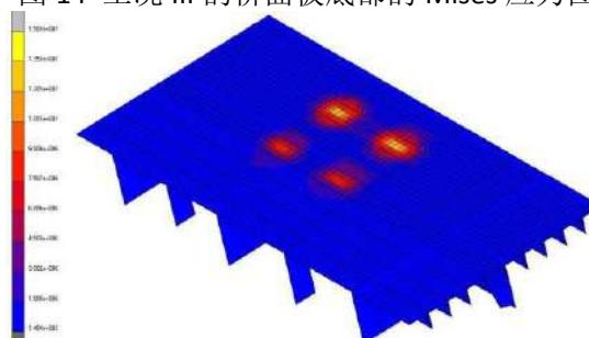
图 15 工况 V 的桥面板底部的 Mises 应力图
