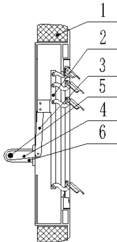
图 5 连杆与活动百叶窗的连接示意图
