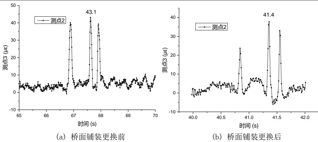
图 24 跑车试验时 A 断面测点的动应变
