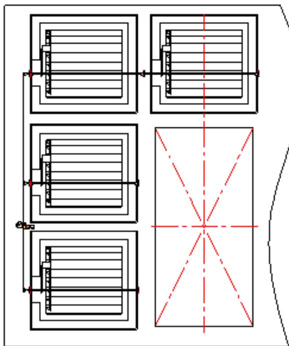
图 4 多个百叶窗的连接方式
