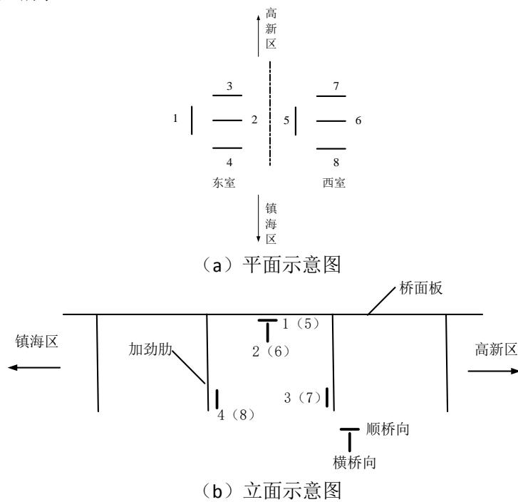
图 4 断面 A 测点布置图
