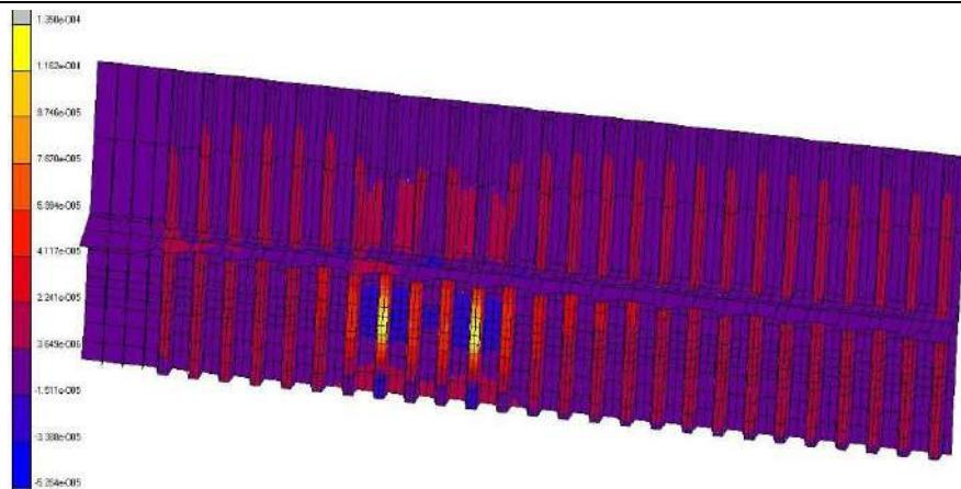
图 16 工况 II 下桥面板底部的顺桥向应变图
