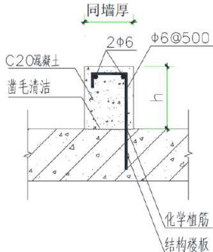
钢筋混凝土反坎做法
