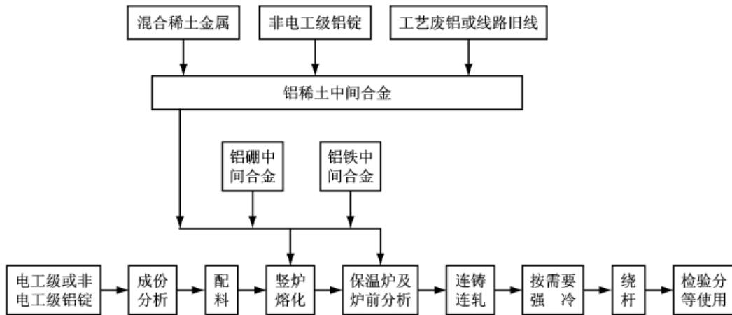
图 1 电工铝杆生产工艺的流程
