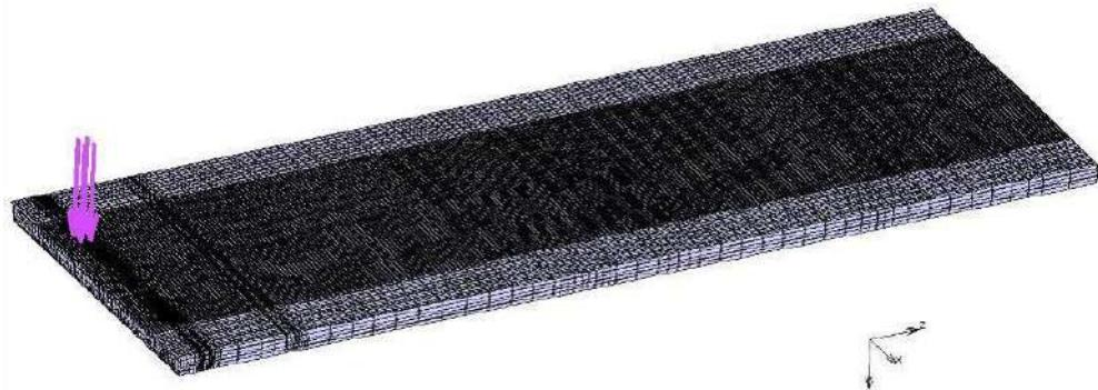
图 8 工况 I、III、V 时载重汽车后桥作用于断面 A
