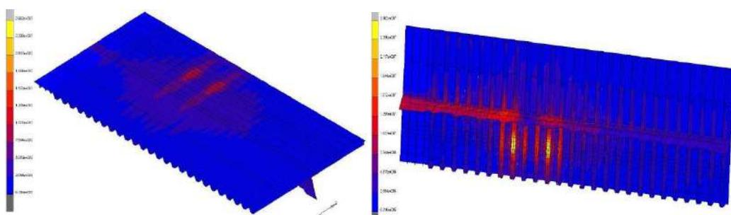
图 19 工况 II 的桥面板底部的 Mises 应力图
