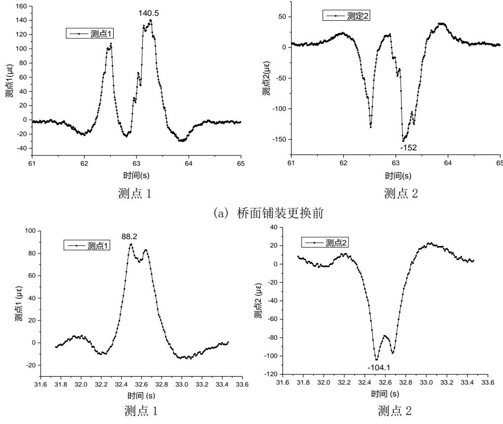
图 25 跑车试验时 B 断面测点的动应变
