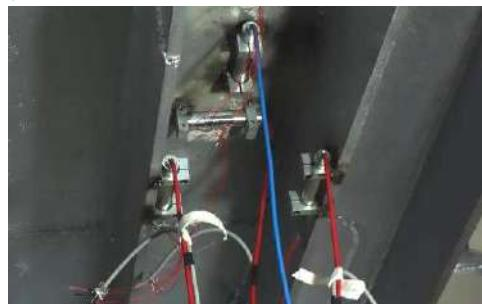
图 3 应变测试仪器布置图
