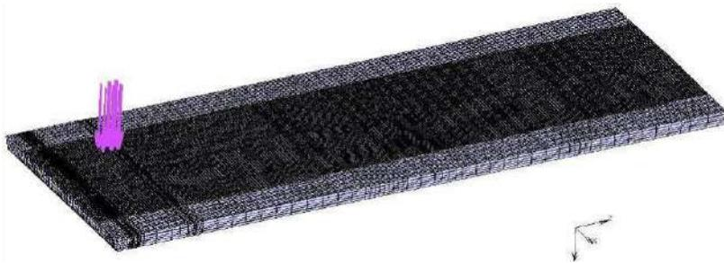
图 9 工况 II、IV、VI 时载重汽车作用于断面 B
