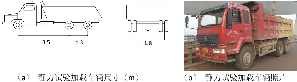
图1 静力试验的加载车辆
