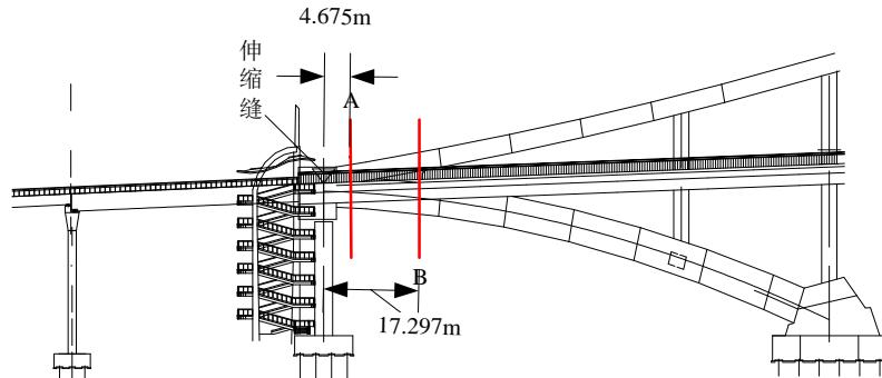
图2 桥梁静载试验的测试断面
