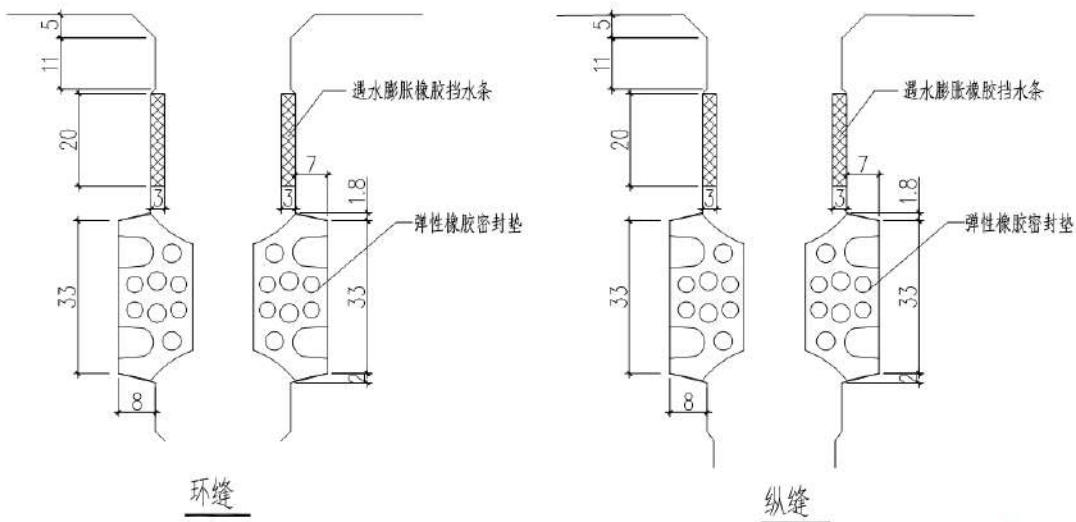
图 1：挡水条与弹性橡胶密封垫设计图
