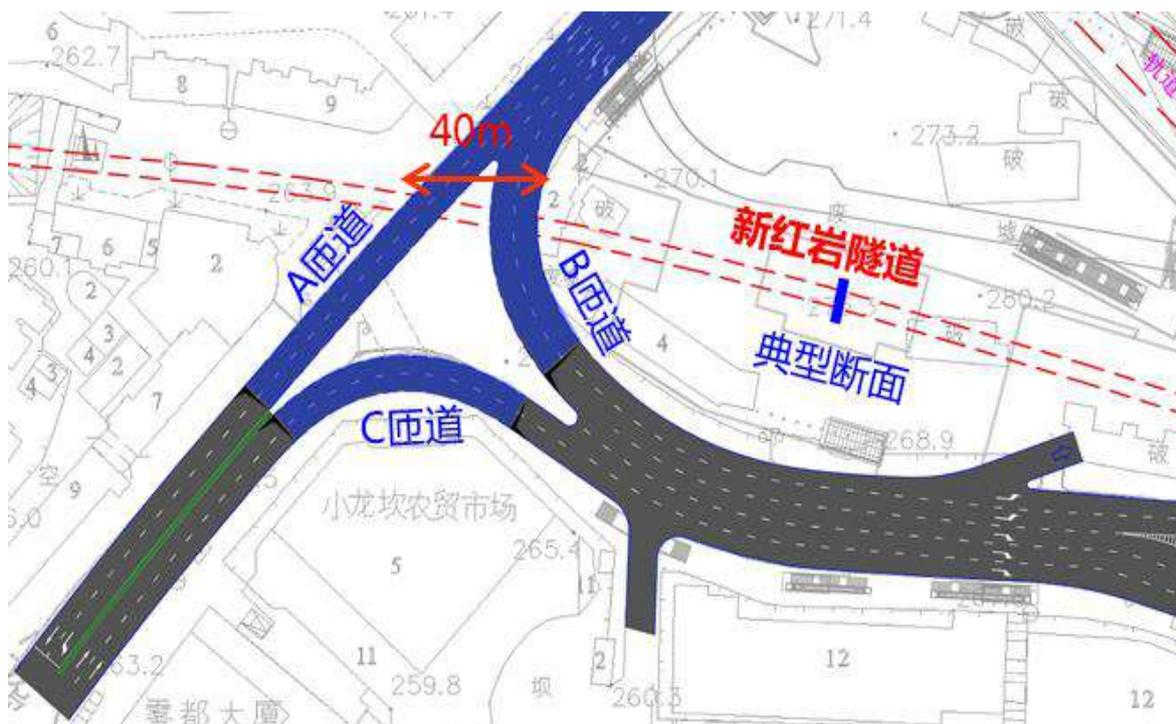
图 2 小龙坎立交既有 A、B 匝道与新红岩隧道平面关系图
