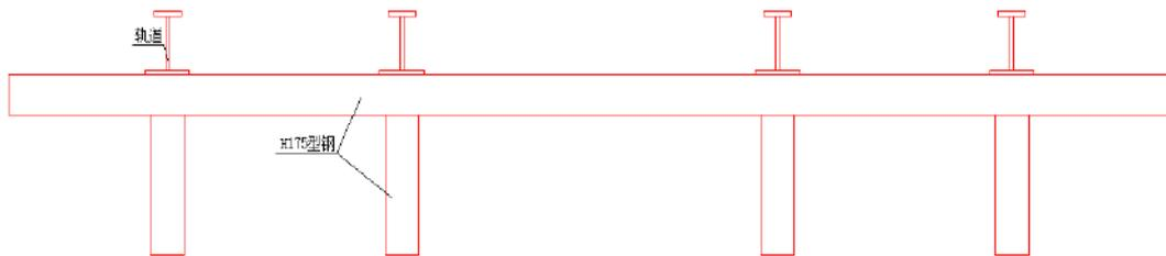
图 6 后配套过站轨道铺设设计横断面图
