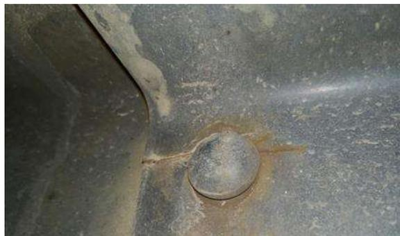
图 1 连接板开裂图示
