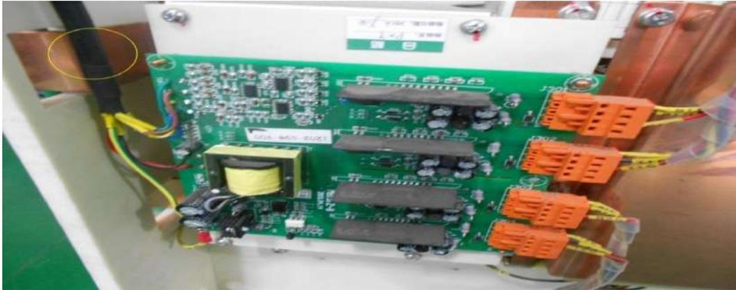
根据上述情况以及其它现场类似故障情况（变频器功率 3500-3750kVA 两个功率段，功率单元为同一种工艺）综合分析认为，造成此次驱动故障的原因有：1. 由于设计缺陷导致单元控制板及驱动板间连接线缆（驱动信号线）与输出母排间距近造成干扰引发驱动故障。2. 由于设计缺陷导致驱动故障检测回路配置不匹配引发驱动故障。
