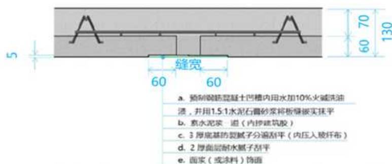
图 12 板缝处理做法图
