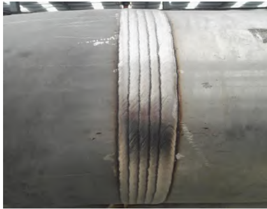
图 8 不锈钢盖面成型示意
