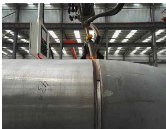
图6 不锈钢填充焊渣自然脱落示意图
