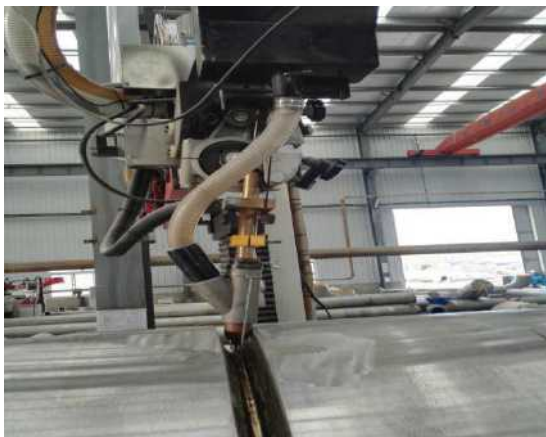
图3 焊枪位置示意图
