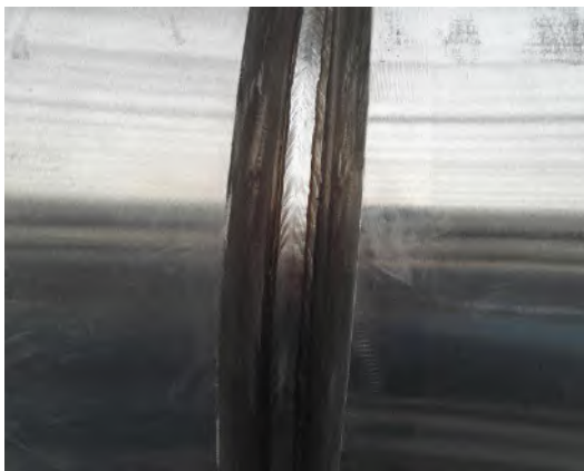
图5 不锈钢热焊层示意图
