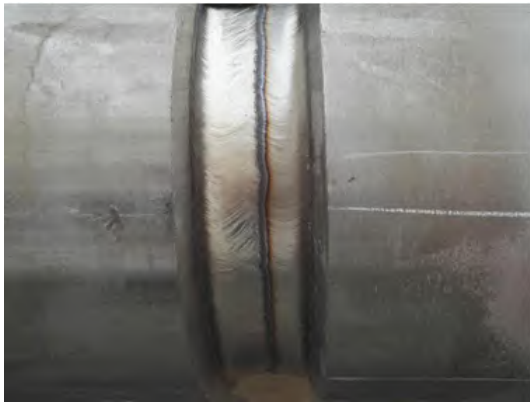
图 7 多层多道焊示意图
