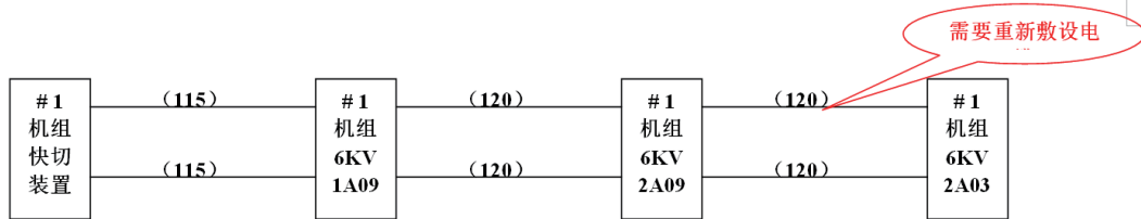
备用分支 1A09 和 2A03 断路器辅助接点电缆联系图
