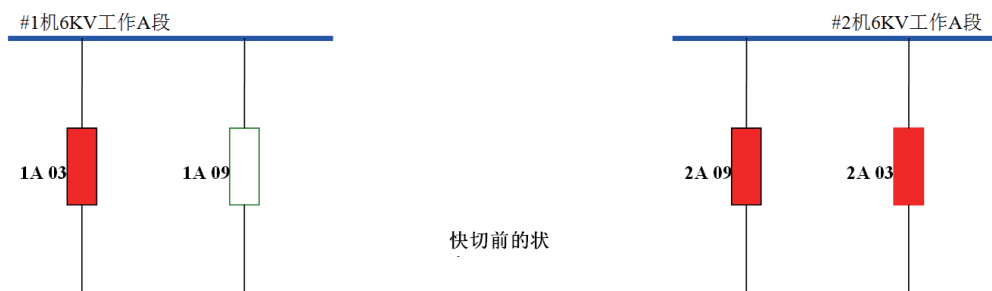
图 3 当 #1 机组发生故障状态时，#2 机组还是处于运行状态；那么 #1 机 6kV 工作 A 段的电压则由 #2 机 6kV 工作 A 段供给。
