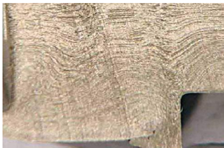
图 2 疲劳源区的显微镜观察结果
