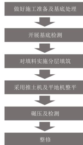
图1 项目公路路基施工工艺流程
