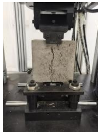
图 4 劈裂抗拉试验
