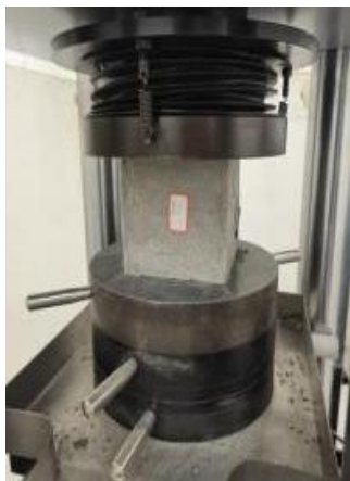
图 3 抗压强度试验
