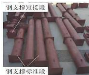
a) 钢支撑标准段及短接段
