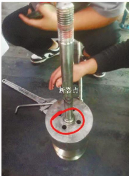
图1 调节阀阀杆断裂点
