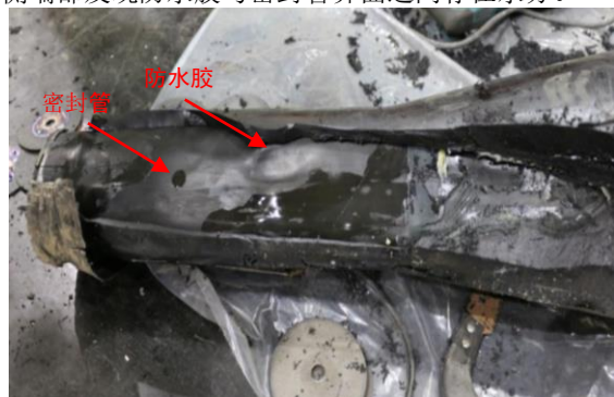
图10 防水胶与密封管界面间存在水分
