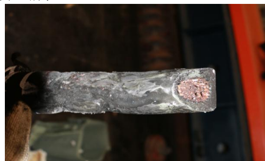
图13 压接管端部导体已熔断
