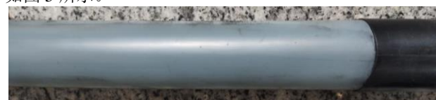
图 5 外半导体断口无应力疏散胶和应力管
