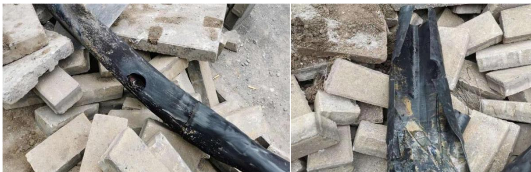
图 2 外护套管内部进水
