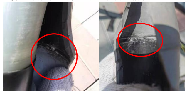
图 20 电缆终端应力锥内侧放电痕迹
