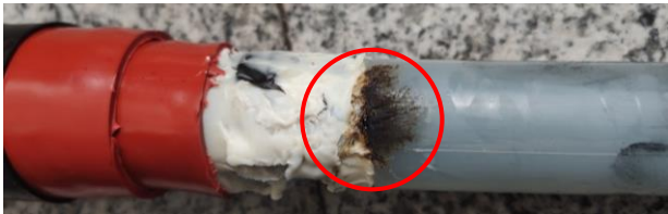
a)主绝缘断口放电痕迹
