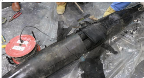
图9 接头防水胶固化情况
