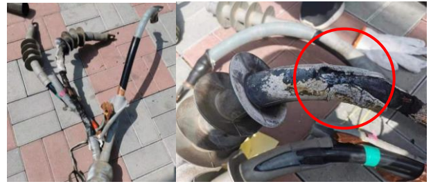
图 17 电缆终端三相应力锥弯折严重
